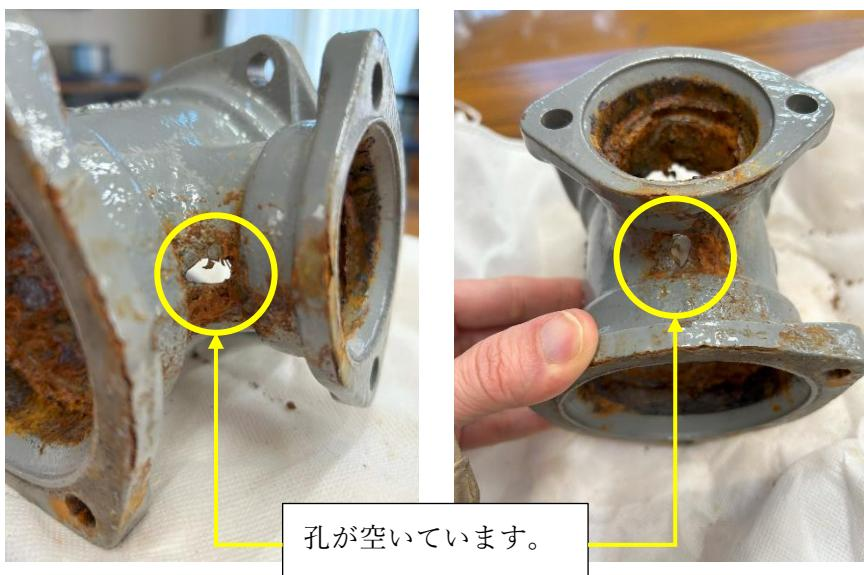
上記の孔は、洗浄痕によって削られていた箇所が腐食して、孔があいたのではと、コンサルタント会社より助言いただきました。洗浄痕は、雑排水管清掃で、ステンレスホースを繰り返し挿入したことによってできたとの事です。現在の雑配水管清掃は、被覆を施したホースで洗浄しています。
